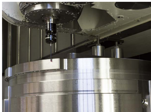
Intoco uporablja merilne sisteme Renishaw za merjenje velikih komponent med proizvodnim procesom
